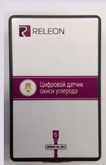
Рис. 11. Датчики кислорода (слева) и угарного газа (справа)
