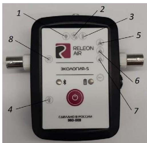
Рис. 2. Мультидатчик по экологии. Обозначение разъёмов и технологических отверстий: 1 — освещённость, 2 — относительная влажность воздуха, 3 — температура окружающей среды, 4 — температура растворов, 5 — нитрат-ионы, 6 — хлорид-ионы, 7 — pH, 8 — электропроводность
