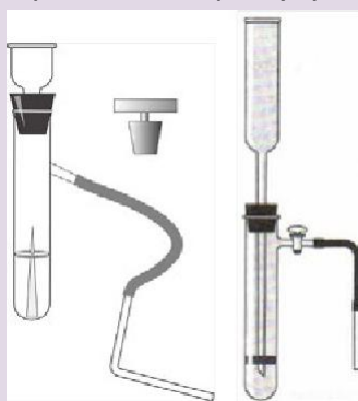
Рис. 7. Прибор для получения и собирания газов
